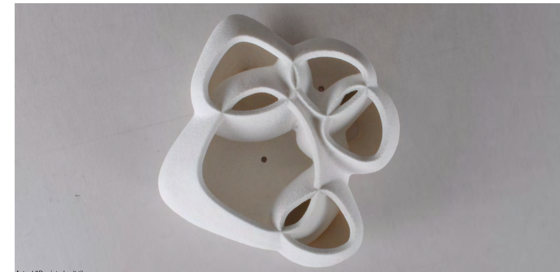
Actual 3D printed salt tile.
